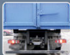
Разнесенные опорные точки оси поворота кузова
